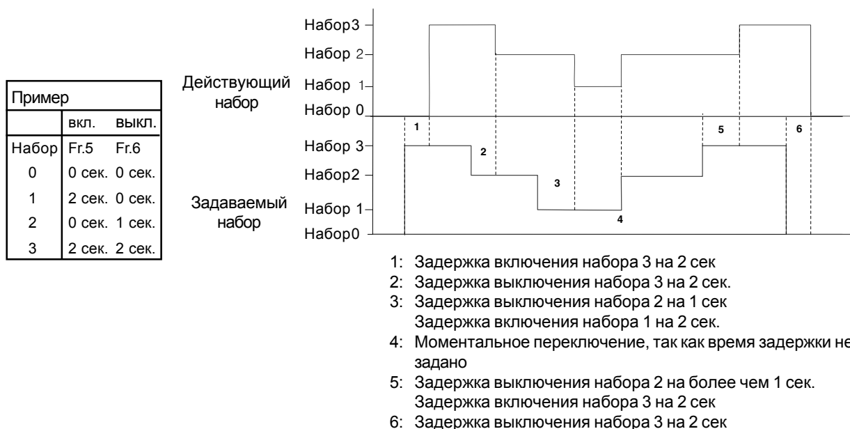
Рис. 6.8.9 Задержка включения/выключения
