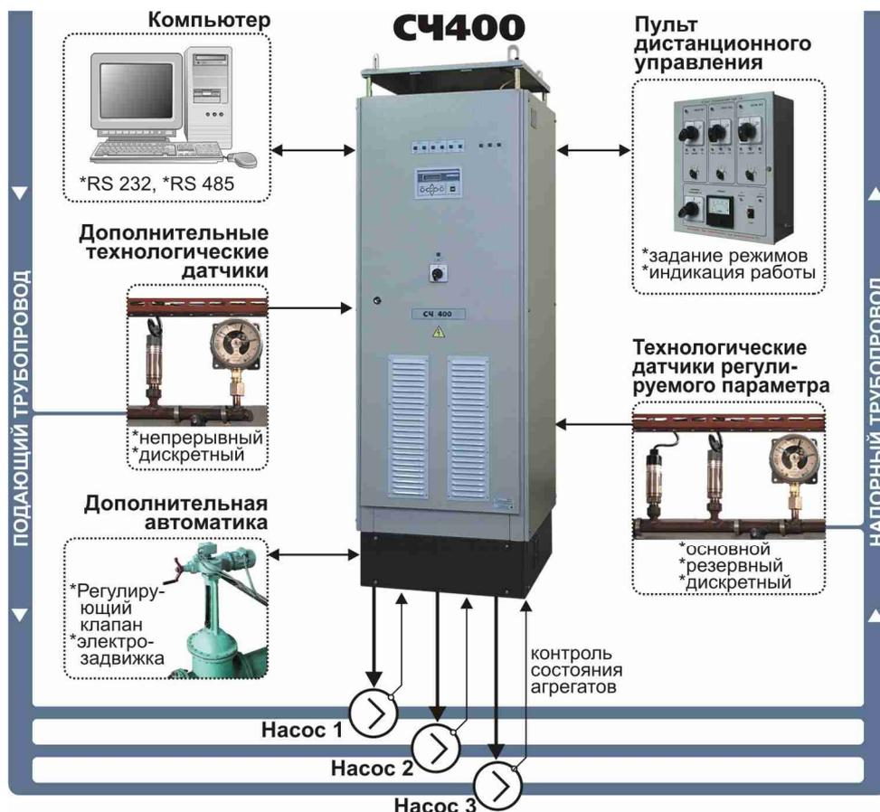
Основными силовыми элементами станции СЧ400 являются преобразователь частоты и коммутационная аппаратура группового управления тремя насосными агрегатами. С помощью коммутационной аппаратуры каждый насосный агрегат может быть подключен либо непосредственно к сети, либо к выходу преобразователя частоты.
