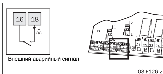
Рис. 65 Соединение клемм для внешнего аварийного сигнала
