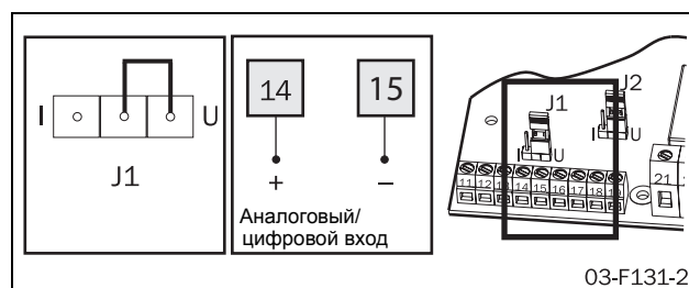
Рис. 54 Подключение для аналогового/цифрового входа и настройка переключки J1 для аналогового контроля силы тока или напряжения.
