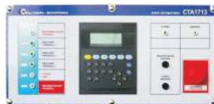
Панель индикации и параметрирования
