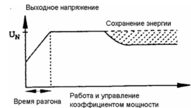
Рис. 17 Управление коэффициентом мощности повышает этот коэффициент при длительной работе двигателя на незначительных нагрузках.
