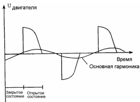
Рис.26 Напряжение на двигателе и его основная гармоника.
